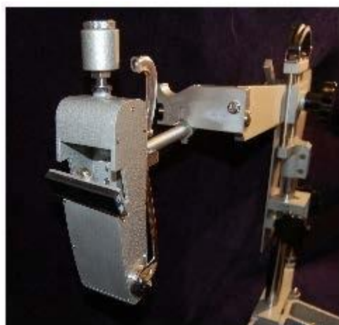
Figura 792 - 4. Detalle del montaje de la zapata de caucho
