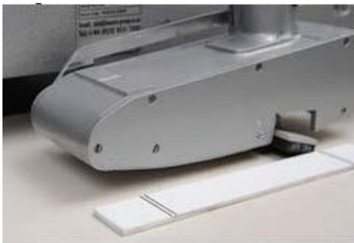
Figura 792 - 7. Medidor de la longitud de contacto
